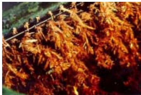
图 10: 金属铜粒正在阴极上生长
