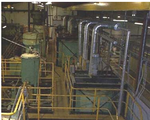
Figura 8: Etapa de lixiviación 1 (derecha, adelante) en la planta de demostración de Cobre Intec.
