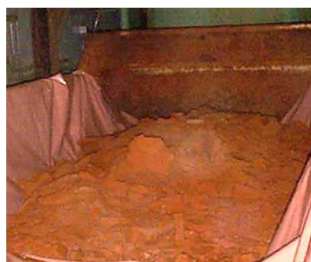
Figura 11: Residuo lixiviado ambientalmente aceptable, listo para el relleno sanitario.
