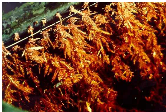
Figura 10: Dendritas de cobre creciendo en el cátodo.
