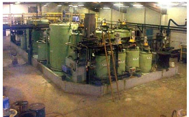
Figura 9: El circuito de purificación en la planta de demostración de Cobre Intec, con reducción cúprica al frente, y purificación pH4 en el fondo.
